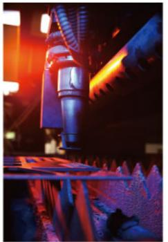
以雷射發振器，將CO<sub>2</sub>氣體電擊整合成0.25mm之直線光，
